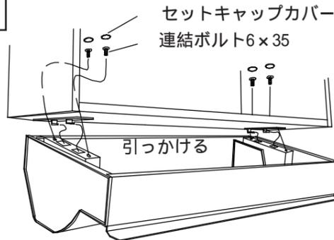
クイックボックス本体を取付金具に引っ掛け、連結ボルト6×35で4ヶ所固定します。連結ボルトが確実に締め付けてあるかを確認してください。セットキャップカバーをボルトの頭に取り付けます。
